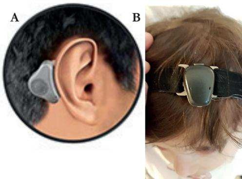
**Figura 8.** Dispositivos de vibración ósea (Bonebridge)
